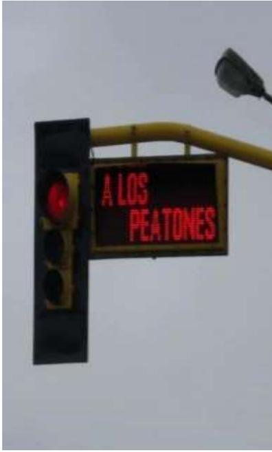
*\* Mantenimiento de 10 telemáforos (paneles electrónicos que accionan con la luz roja del semáforo emitiendo mensajes alusivos a seguridad vial y respeto a las normas de tránsito)*
